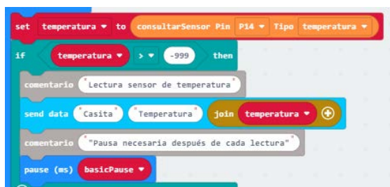
Fig. 5: Ejemplo de envío de datos de temperatura
