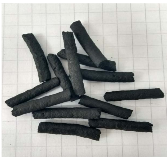
Figura 1: Imagen fotográfica de pellets con Aluminio uniformes en forma y tamaño.
