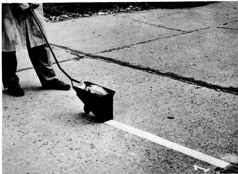
Fig. 2.- Aplicación sobre pavimento para ensayo en servicio
