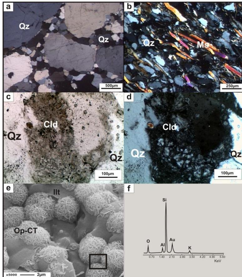
**Figura 3:**(a-d) Fotomicrografías con microscopio petrográfico (a, b, d: nicoles cruzados, c: nicoles paralelos). (e) MEB del material relleno de poros. (f) Espectro del recuadro en (e). **Qz:** cuarzo, **Ms:** muscovita, **Cld:** calcedonia, **Op-CT:** ópalo-CT, **Illt:** Illita.
