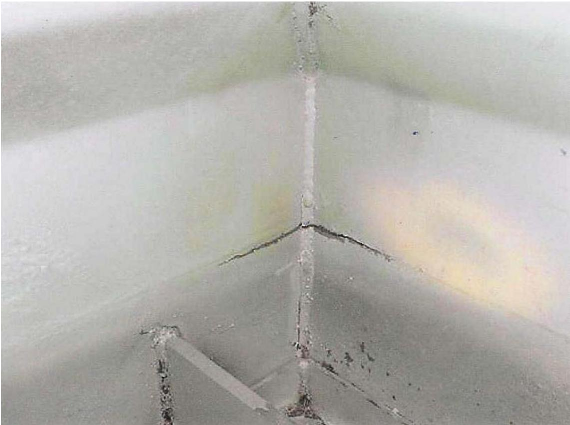
Figura E.1: Rotura en esquina tolva de salida
