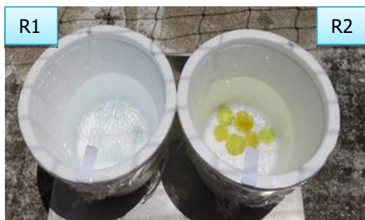
Fig. 4: Arreglo experimental destinado a la "cosecha de energía". Recipiente ubicado a la izquierda (R1): discos de vidrio sin AgNPs. Recipiente ubicado a la derecha (R2): discos de vidrio con AgNPs.
