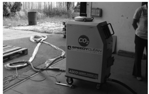
Figura 14: Equipo de crioarenado. Se observa el tanque de reserva de CO 2 congelado y granulado.
