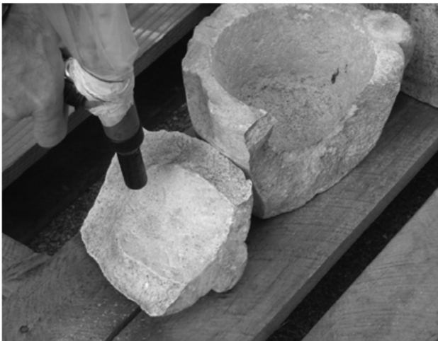
Figura 16: Pistola de aire comprimido lanzando un chorro de CO 2 congelado y granulado.
