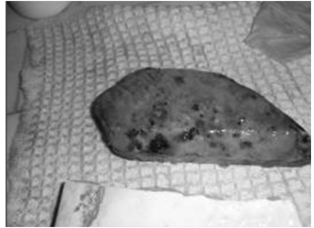
Figuras 40 y 41: Aplicación de biocida en rocas sin y con biofilm y su posterior reacción.
