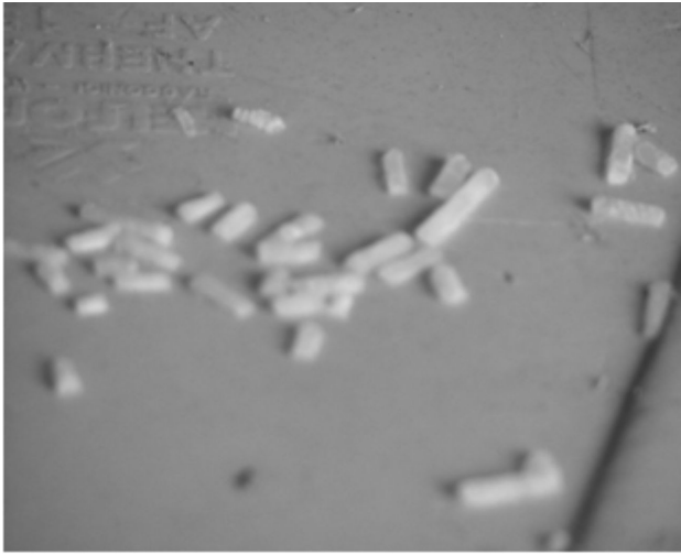
Figura 15: Detalle de CO 2 congelado y granulado en el tanque de reserva y gránulos de CO 2 congelado.
