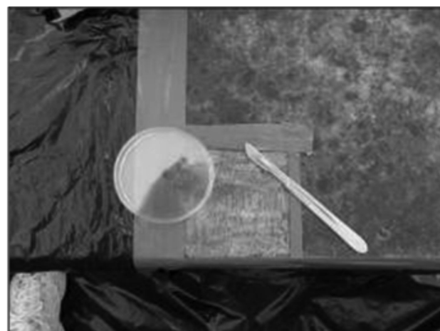
Figura 35: Raspado de la superficie para su posterior análisis en laboratorio.
