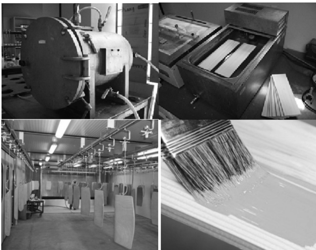
Figura 6. Diferentes métodos de aplicación de los tratamientos preservantes para maderas: a) impregnación, la foto muestra el autoclave en donde se introducen las maderas a tratar; b) inmersión, se observa dispositivo donde las maderas son sometidas a agitación, inmersas en la solución tratante; c) cámara de pintado por pulverización, utilizado generalmente para líneas de fabricación de piezas de madera y d) pintado con pincel, método comúnmente empleado para la aplicación de pinturas protectoras.
