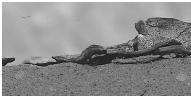
Figura 9: Imagen al Microscopio. Se observa la fijación del líquen sobre la superficie de la teja.
