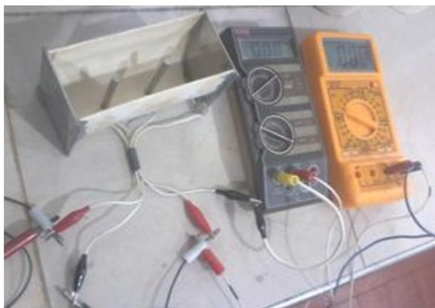
**Figura 3:** Dispositivo empleado para la medición de la conductividad eléctrica.
