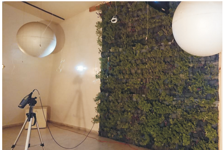
Muestra de sistema modular de jardín vertical en cama reverberante
