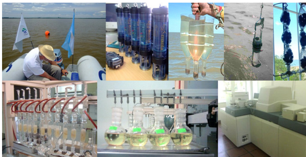
Imagen 2. Trabajo de muestreo en el Río Uruguay con sondas ambientales, trampas de sedimento, testigos de sedimentos y bivalvos centinelas preparados para el despliegue en el río (arriba, de izquierda a derecha). Procesamiento en el laboratorio, extracción, concentración de extractos y determinación de contaminantes en espectrómetro de masas de alta resolución (abajo)
