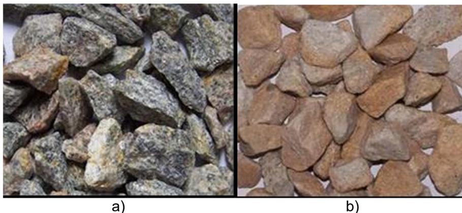
Figura 3.1. Agregados gruesos a) Granítico y b) Cuarcítico
