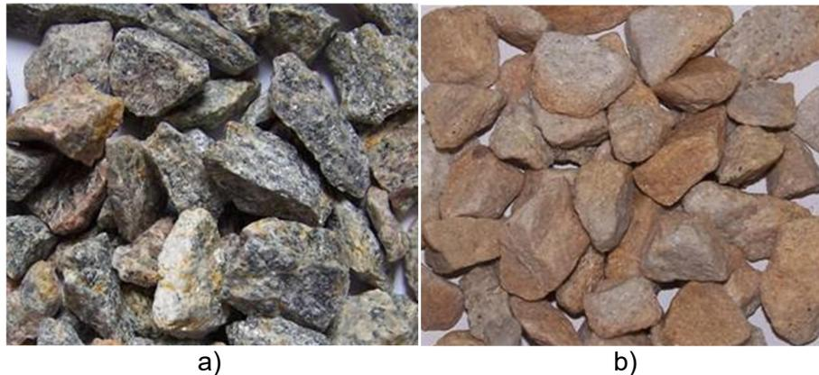
Figura 4.1. Agregados gruesos: a) granítico, b) cuarcítico
