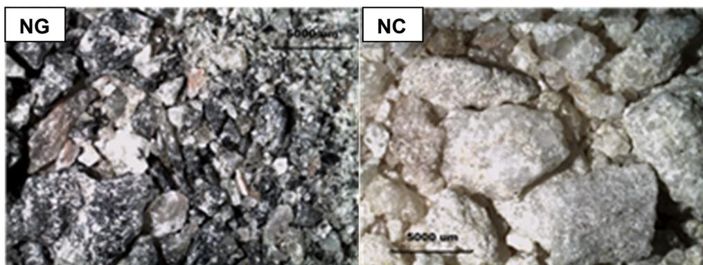
Figura 4.3. Imagen con lupa binocular de los agregados finos naturales
