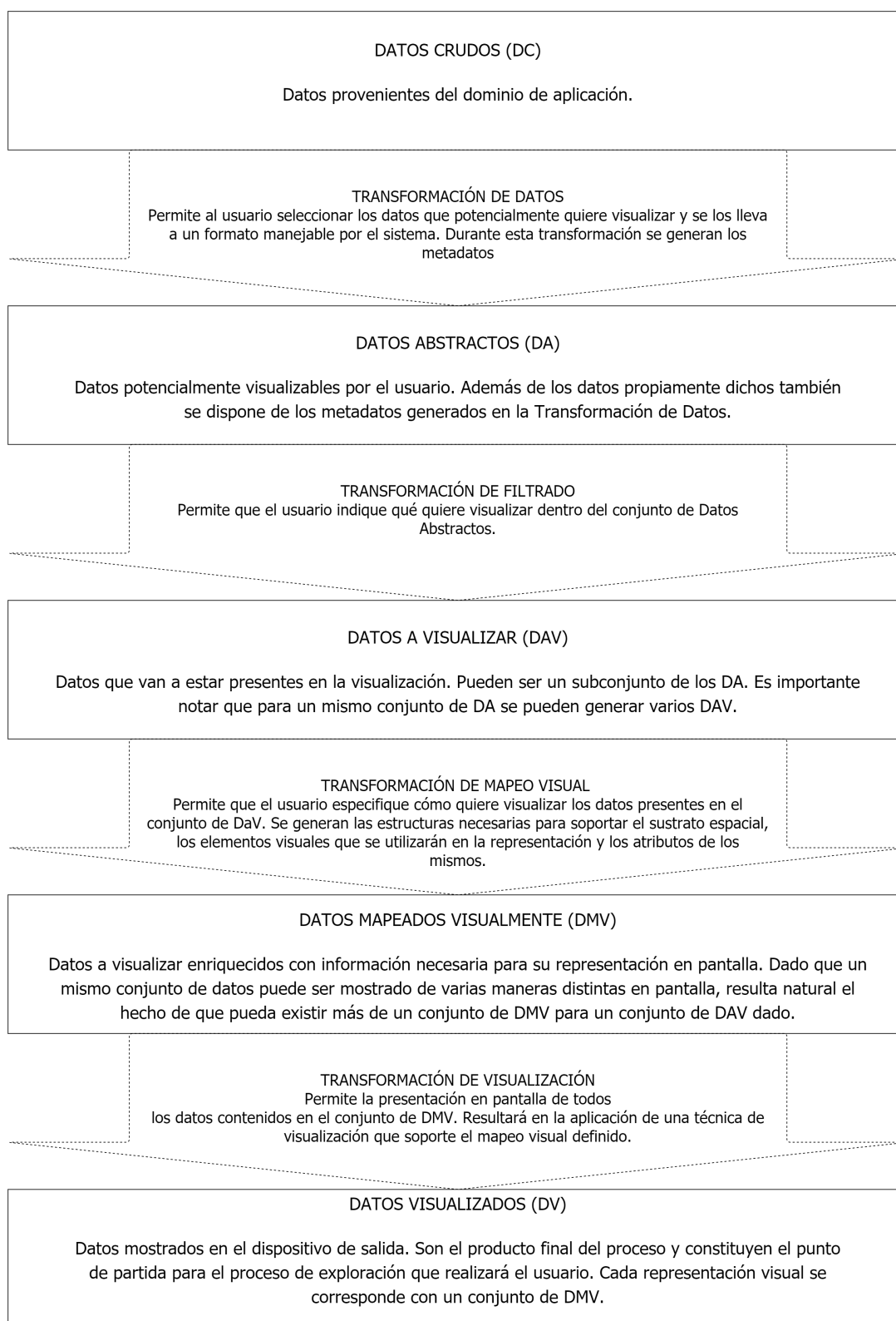
Figura 2.18: Estados y Transformaciones en el Modelo Unificado de Visualización.
