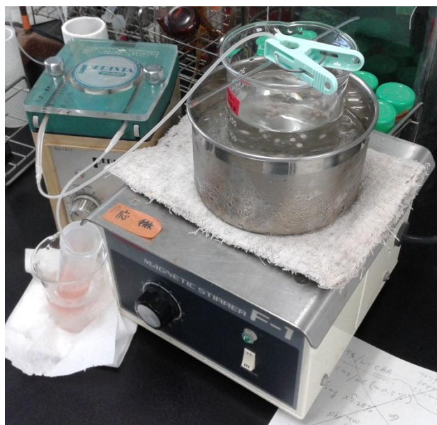
Figura 5.4. Sistema de inmovilización de células catalíticas.
