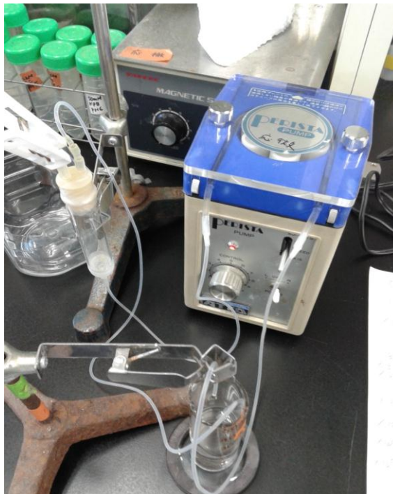
Figura 5.8. PAL pura inmovilizada en columna con recirculación.
