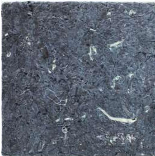
Material: Adhesivo Vinilico de secado rápido + denim
