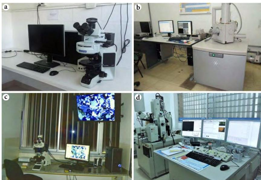
**Figura 1.4.** Equipos utilizados para el estudio petrocalcográfico y químico de las unidades del Complejo Martín García. a) Microscopio petrocalcográfico Olympus (BX53) ubicado en el INREMI. b) Microscopio electrónico de barrido (FEI Quanta 200) con EDS ubicado en el LIMF. c) Microscopio petrográfico Leica (DM 4500 P LED) ubicado en el CICTERRA. d) Microsonda electrónica (JEOL JXA-8230) ubicada en el LAMARX.
