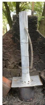
Figura 2: Horno de carbonización funcionando. Es una combustión limpia, no genera gases tóxicos.
