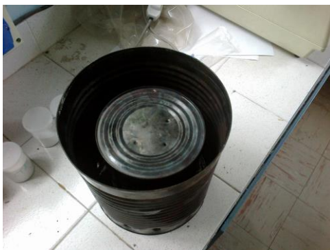
Figura 1: Corazón del horno de carbonización. Consiste en una lata grande con agujeros a los lados en la parte inferior y una lata pequeña invertida, con 3 agujeritos en su base, dentro de la cual irá la biomasa a
