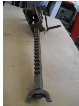
Figura 13 - Elementos y criques utilizados por el "Canario" para trasladar las viviendas.
