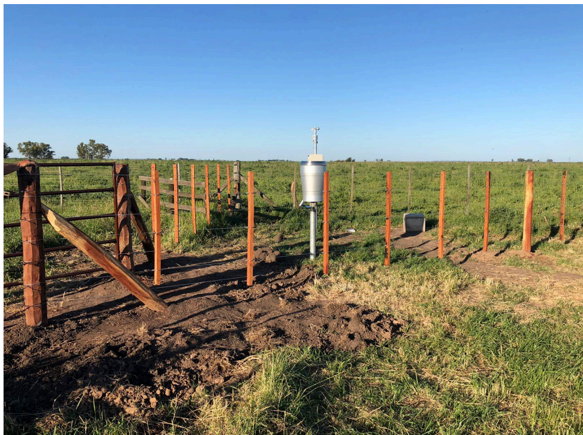
Figura 7: Disposición final de estación freaticométrica.
