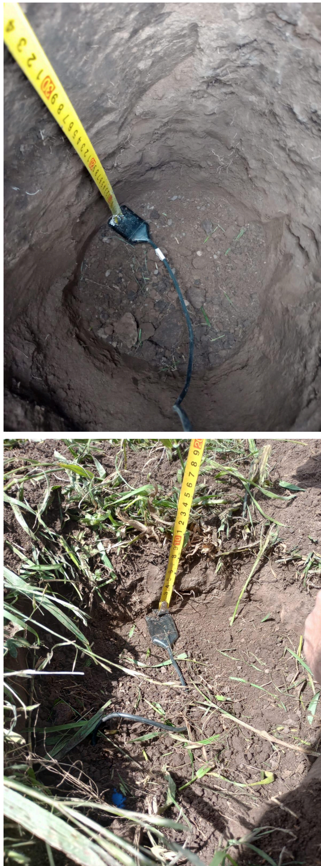
Figura 5: Ubicación de los sensores de humedad del suelo (a 10 y 60 cm).
