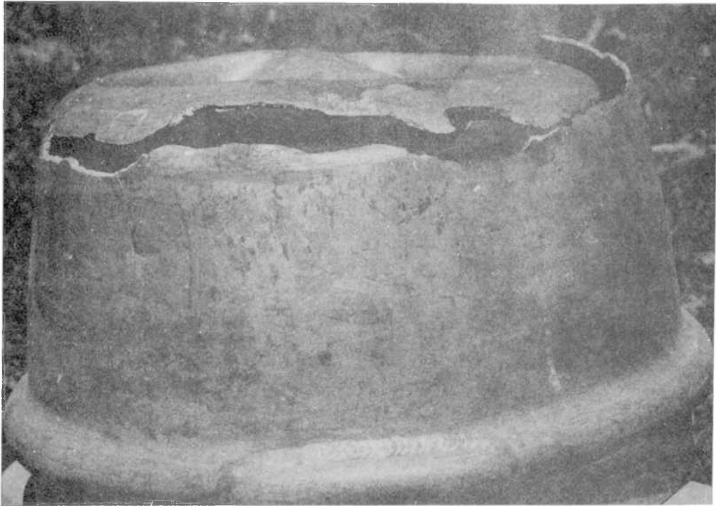
Figura 1 (X 0,4).- Aspecto del barril luego de la prueba de estanqueidad correspondiente al fondo
