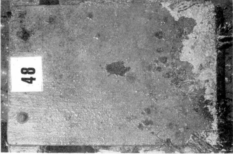
Fig. 4.- Paneles correspondientes a la pintura n° 18 luego de 12 meses de inmersión en la balsa experimental (47, elaborada en molino de 3,3 litros; 48, en molino de 28 litros)
