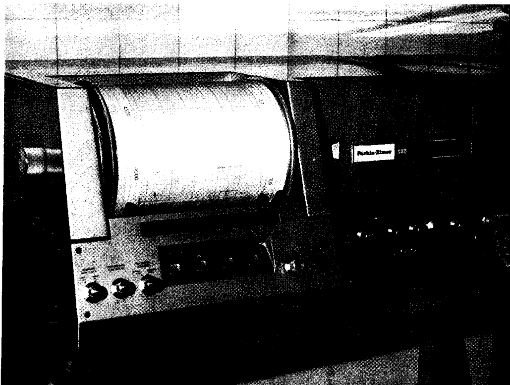
Espectrofotómetro infrarrojo, para determinación de grupos funcionales en compuestos orgánicos y en sus mezclas
