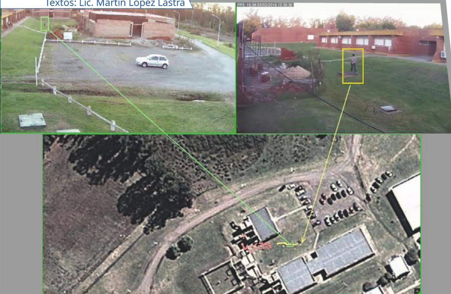
El sistema diseñado en PLADEMA permite configurar una señal de alerta automática (sonora, visual, telefónica), independiente de la presencia de un supervisor. Por ejemplo, en un objetivo de amplias dimensiones (foto inferior) se puede activar una señal ante la presencia de una persona extraña (fotos superiores) en un determinado horario en zona de acceso restringido y programar con qué cámara captar mejor al intruso.
