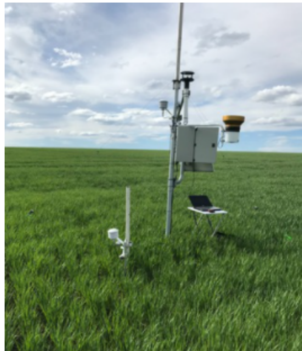
Figura 3.5: Estación de Balance de Energía (EB+) instalada en el cultivo de cebada en la estancia La Alcira, Tandil. La disposición de los sensores (en el plano de flujo cero=altura de la vegetación) de vegetación se reubican a medida que el cultivo se va desarrollando y los restantes se mantienen a altura fija.
