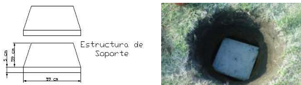
Figura 4.a) Estructura de soporte y dimensiones y b) pozo con planchas dispuestas para sustentación final del lisímetro.
