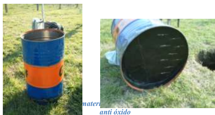
Figura 6. Cilindro sin material y fondo del lisímetro con protección antióxido
