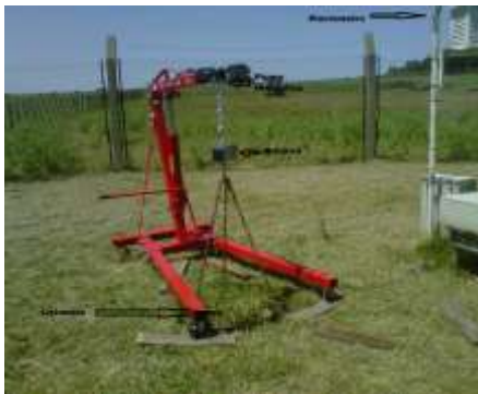
Figura 8.a) Pluma hidráulica sosteniendo la estructura b) Balanza colocada lista para medir.
