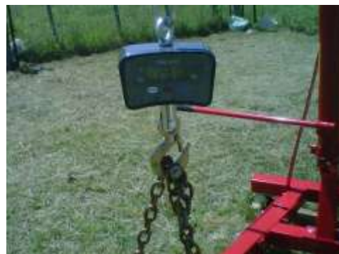
Figura 8.a) Pluma hidráulica sosteniendo la estructura b) Balanza colocada lista para medir.
