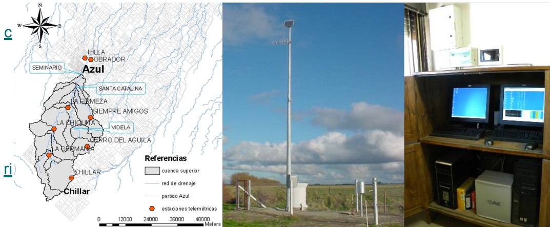
Figura 1: Estaciones telemétricas: ubicación, predio y centro de control de la red de alerta temprana de inundación de la ciudad de Azul.
