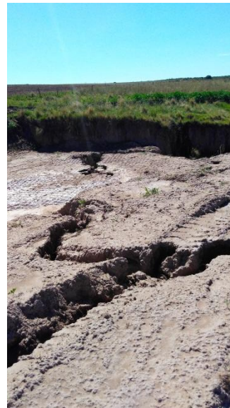
Figuras 7 y 8. Formación de tubos verticales y micro-carcavamientos.
