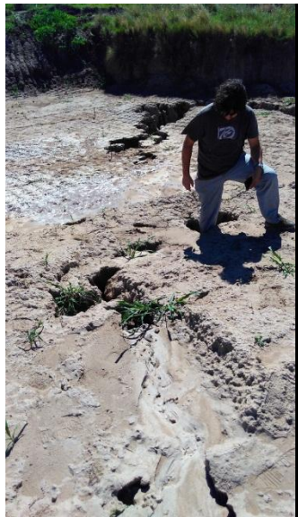
Figuras 7 y 8. Formación de tubos verticales y micro-carcavamientos.
