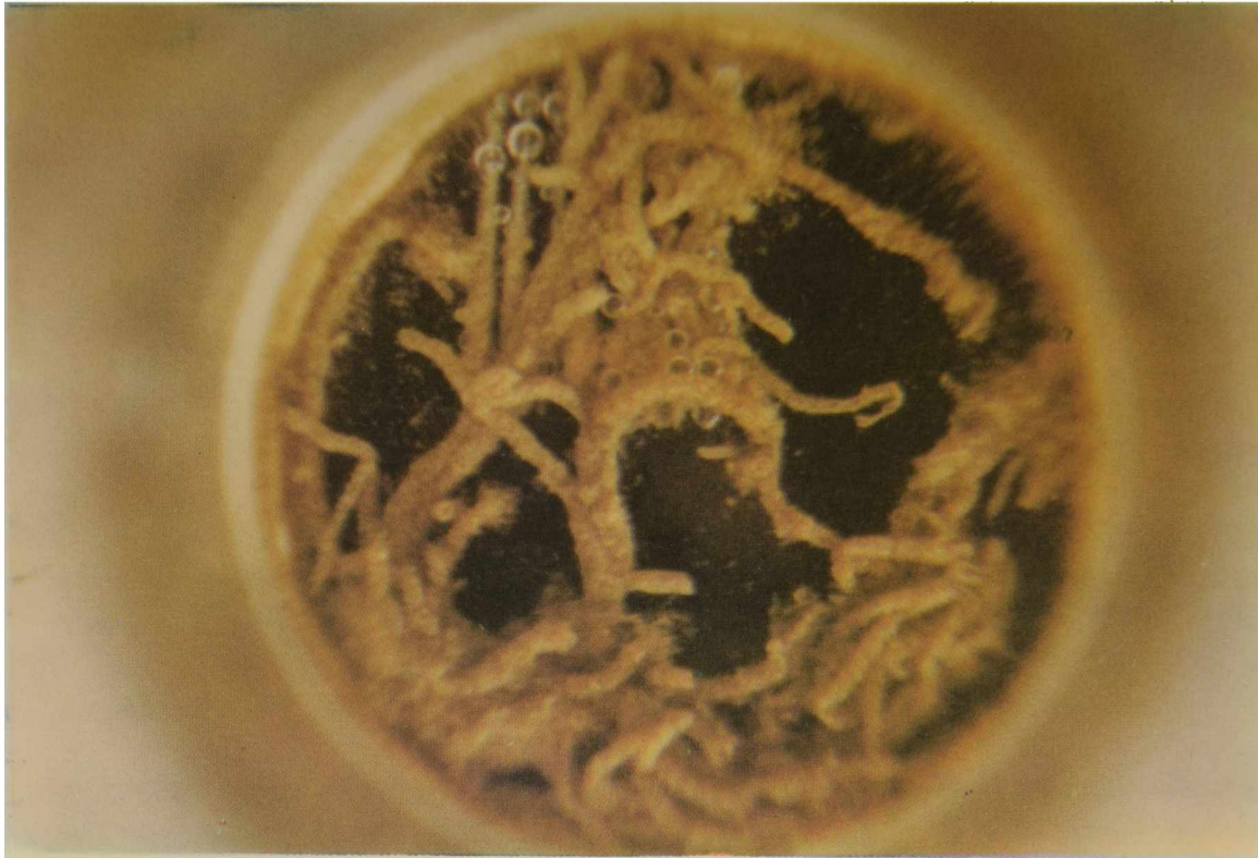
Fig. 3. Probeta tipo (a), a tiempos de ensayo mayores. Se ven burbujas de hidrógeno sobre la falla del recubrimiento.
