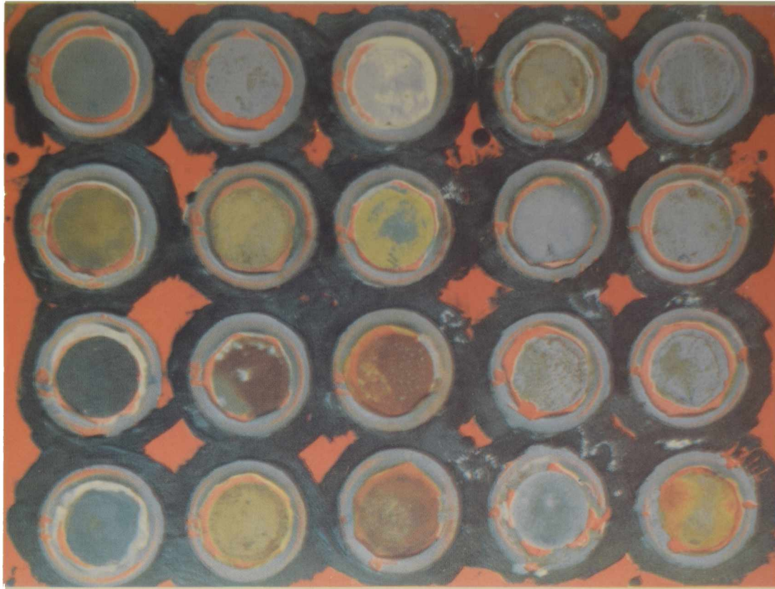
Fig. 4. Corrosión observada luego del ensayo galvanostático de 20 soluciones.
