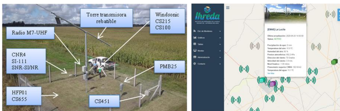
Figura 1. EMBE 45. Parcela de 10 metros por 10 metros con transmisión por radio. Sensores: PMB25 (Pluviómetro), CNR4 (Radiación neta), SI-111 (Temperatura Radiativa), SNR-SI/NR (Reflectancia espectral), HFP01 (Flujo de calor en el suelo), CS655 (Humedad y temperatura del suelo), CS215 (Temperatura y humedad del aire), CS100 (presión atmosférica), CS451 (Nivel freático y temperatura del agua) (izquierda), y visualizador web (derecha).
