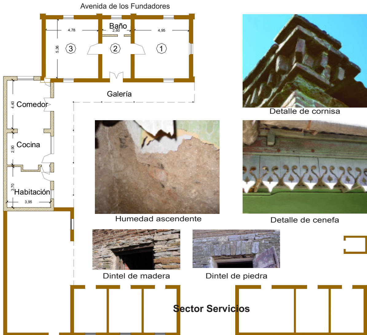
Figura 1: Casa Wagner. Planta y detalles constructivos.
