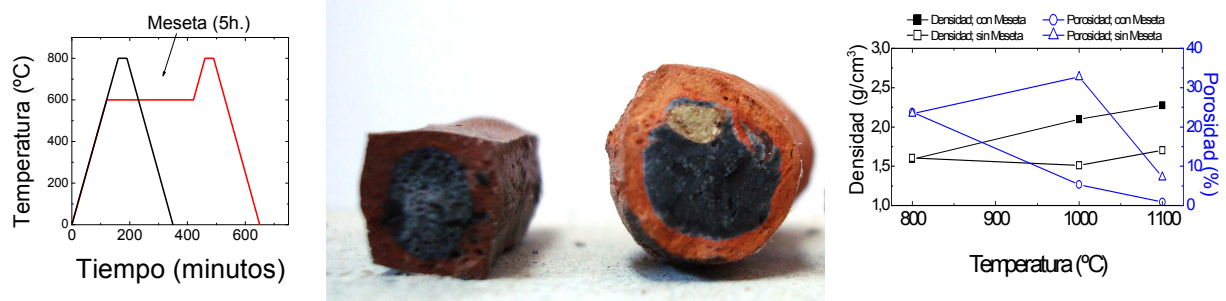
Figura 1: Programas de temperatura, imagen de los materiales elaborados junto a la evolución de la densidad y la porosidad en función del programa de temperatura.
