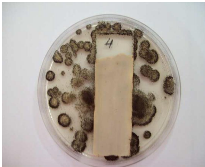
Figura 6: Pintura al látex con zeolita impregnada con \text{Ag}^{+1} en el cultivo de Aspergillus niger , ( 600 \text{ mg.L}^{-1} \text{ Ag}^{+1} ).
