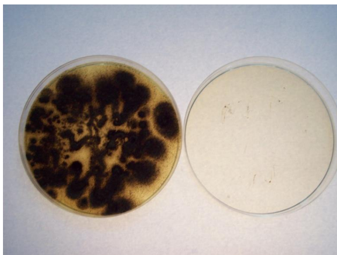
Figura 4: Izquierda: cultivo de Aspergillus en agar-agar. Derecha: cultivo de Aspergillus en agar-agar con la zeolita biocida incorporada, no se registró crecimiento del hongo.
