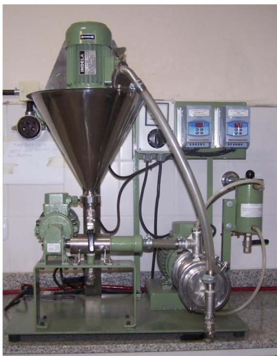
Figura 5: Molino Combimil Mini instalado en el Laboratorio de Ingeniería Química de la UTN- FRLP
