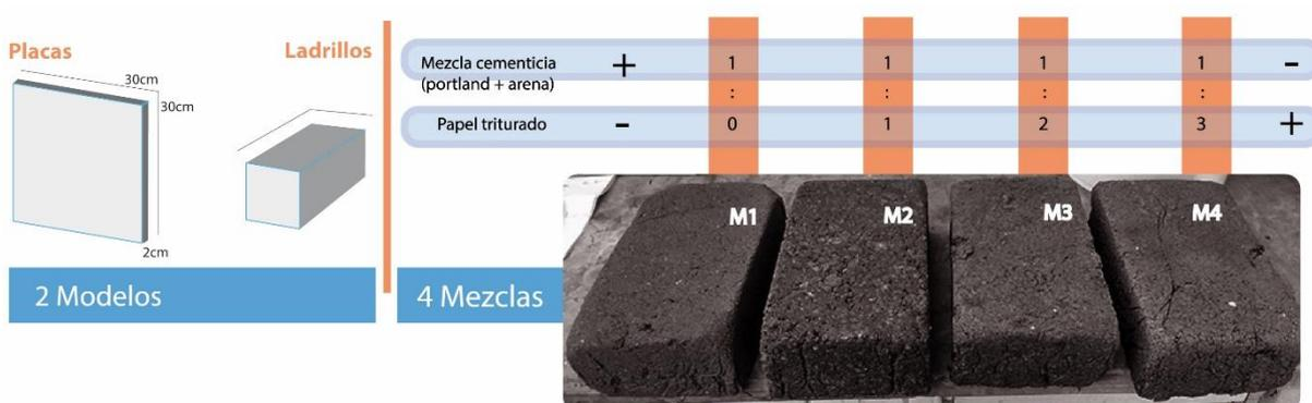
Figura 6- Modelos y mezclas de los prototipos realizados. Ilustración de la autora.
