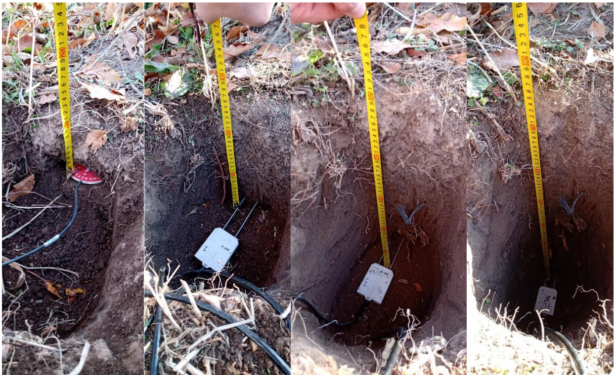
Figura 4. Ubicación de los sensores CS655 y HFP01.
