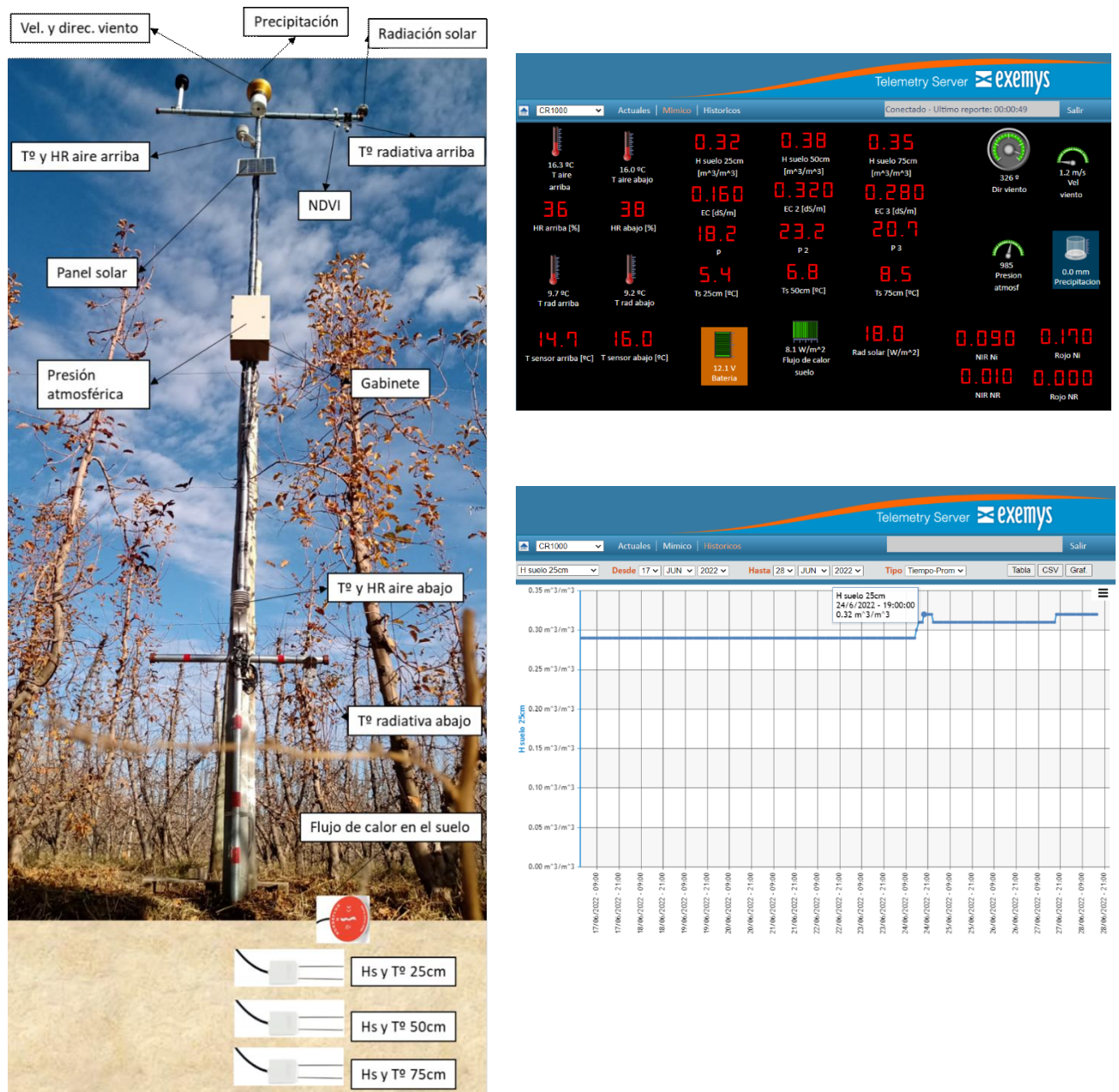
Figura 5. Visualizador de Exemys e identificación de cada variable en la estación.
