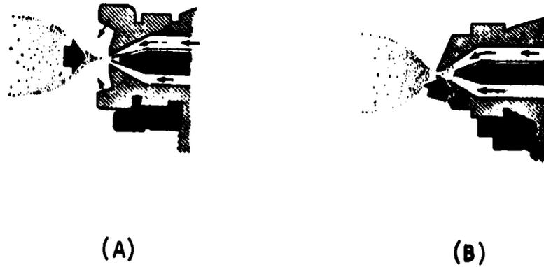
Figura 13.- Sistema de pulverización con mezclado externo (A) o con mezclado interno (B) (32)
