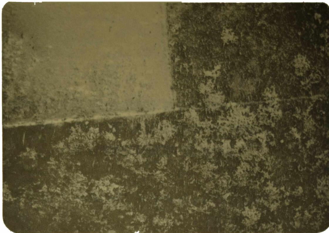
*Figura 5.- Remolcador ARA "Chiriguano": contraste entre la protección que proporciona la pintura 1, costado babor (arriba, izquierda) y el resto del casco de la embarcación*
